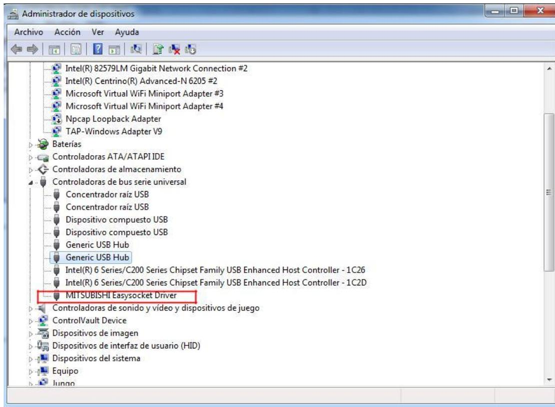
**Una vez finalizada la instalación, puede utilizar el cable USB para descargar el PLC programa.**
